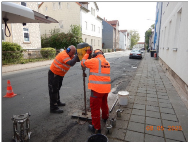
Abb.2-4: Durchführung der Kleinrammbohrungen (KRB); oben links KRB 4, oben rechts KRB 10, unten links KRB 14
