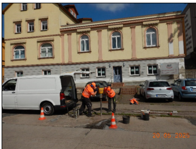
Abb.2-4: Durchführung der Kleinrammbohrungen (KRB); oben links KRB 4, oben rechts KRB 10, unten links KRB 14
